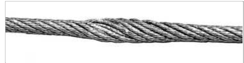
Halatın belli bir noktasında yassılaşıma var. Bu durum, halatın ezilmesi sonucu meydana gelir.
