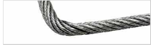
Halat içinde bir kıvrım var. Bu kıvrım, dıştan zorlanma sonucu halata kuvvet uygulandığında oluşur.
