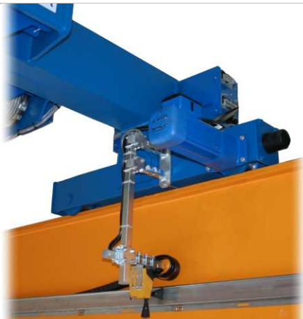
Kruisschakelaar als eindschakelaar loopwerk loopkat
