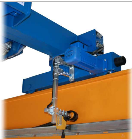
Krydsarmafbryder som endestopafbryder for løbekatkørsel
