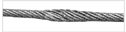
Halatın belli bir noktasında yassılaşma var. Bu durum, halatın ezilmesi sonucu meydana gelir.
