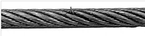
Pęknięcie drutu z odstającym drutem.
