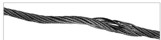
Det har oppstått en kurv i vaieren. Oppstår f.eks. pga. kraftig dreining på vaieren.
