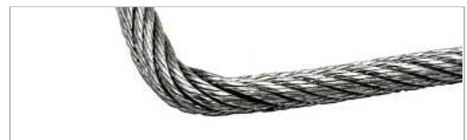
Knekk i vaieren. Oppstår f.eks. pga. kraftig ytre påvirkning på vaieren.
