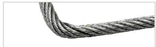
De kabel bevat een knik. Deze ontstaat bijvoorbeeld door brute, externe krachtingwerking op de kabel.
