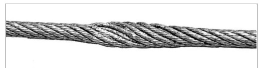
De kabel is op een plek plat geworden. Dit gebeurt bijvoorbeeld door beknelling van de kabel.
