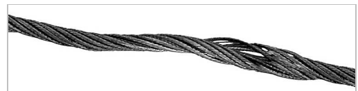
In de kabel heeft zich een korf gevormd. Deze ontstaat bijvoorbeeld door het bruto opendraaien van de kabel.
