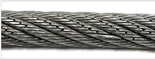
Meerdere draadbreken. Draadbreken zijn tekenen van normale slijtage van de kabel. Ze ontstaan wanneer de kabel onder last op de kabelschijven wordt gebogen.
