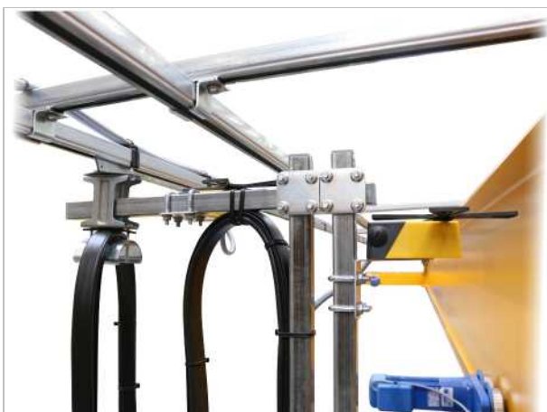
Interruttore con leva a croce come interruttore di finecorsa della traslazione del carrello
