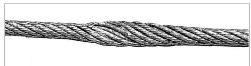
Vaijeri on litistynyt jostakin kohdasta. Näin tapahtuu esim. vaijerin jäädessä puristuksiin.
