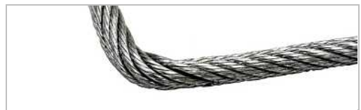
Vaijerissa on taitekohtia. Näitä syntyy esim. vaijeriin kohdistuvan suuren ulkoisen voiman vaikutuksesta.
