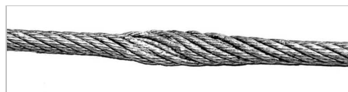
Wiren er fladtrykt på et sted. Dette opstår f.eks. som følge af klemning af wiren.
