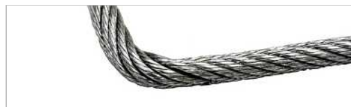
V laně je zlom. Vzniká např. násilným vnějším působením síly na lano.
