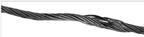
Halatta bir "kuş kafesi" halat hasarı meydana gelmiş. Bu "kuş kafesi", halatın zorla döndürülerek açılması sonucu oluşur.
