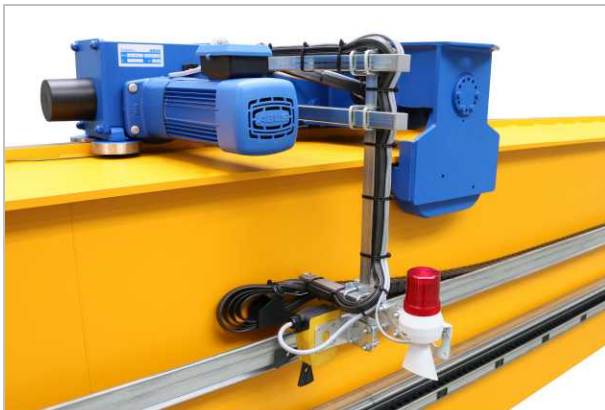
Kedi arabası hareketi sınır anahtarı olarak çapraz kol anahtarı
