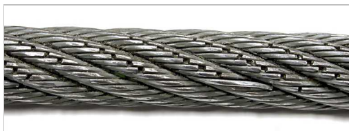
Szereg pęknięć drutów. Pęknięcia drutów to objawy normalnego zużycia liny. Powstają, gdy lina jest zginana pod obciążeniem na krążkach linowych.
