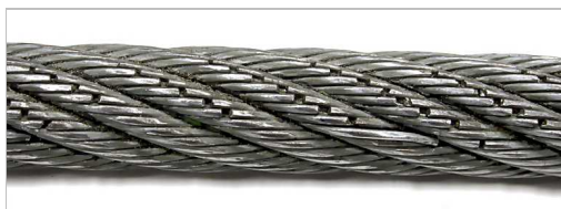
Flere kabelbrudd. Kabelbrudd er tegn på normal slitasje på vaieren. De oppstår når vaieren bøyes på vaierullene under last.
