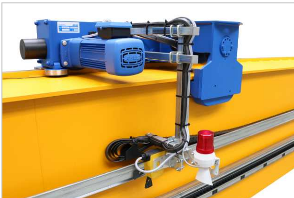
Kruisschakelaar als eindschakelaar loopwerk loopkat
