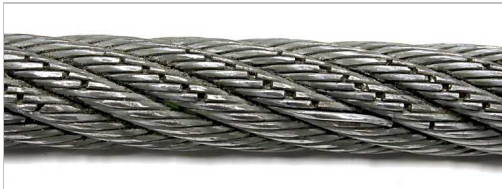
Meerdere draadbreken. Draadbreken zijn tekenen van normale slijtage van de kabel. Ze ontstaan wanneer de kabel onder last op de kabelschijven wordt gebogen.
