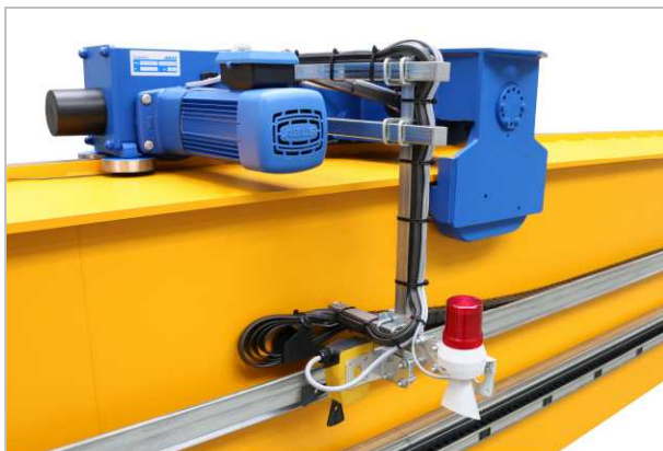
Interruttore con leva a croce come interruttore di finecorsa della traslazione del carrello
