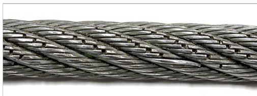
Useita lankakatkoja. Lankakatkot ovat merkkejä vaijerin normaalista kulumisesta. Niitä syntyy, kun vaijeri taipuu kuormitettuna vaijeripyörien päällä.
