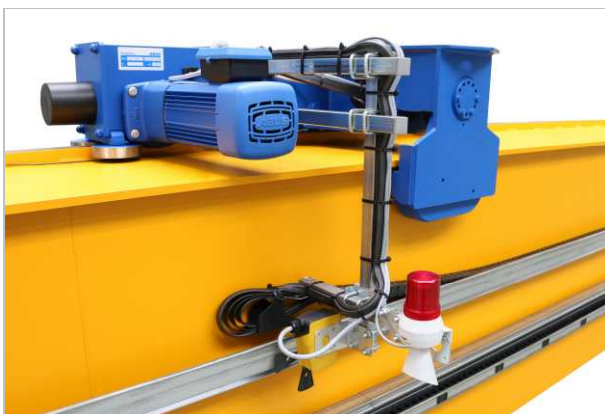
Σταυρωτός οριακός διακόπτης ως οριακός διακόπτης κίνησης βαρούλκου
