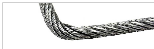
Der er et knæk på wiren. Det opstår f.eks. som følge af voldsom ydre kraftpåvirkning på wiren.
