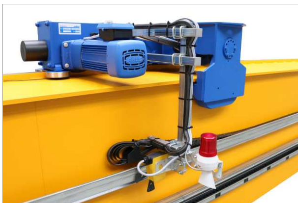
Krydsarmafbryder som endestopafbryder for løbekatkørsel
