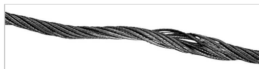
Der er dannet en kurv i wiren. Den opstår f.eks. som følge af voldsom sning af wiren.
