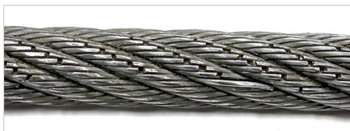
Flere trådbrud. Trådbrud er tegn på normalt slid på wiren. De opstår, når wiren bøjes om trisserne under belastning.
