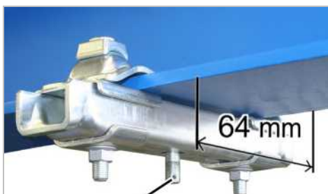
Górne gniazdo wieszaka 2LP/M16 lub M20 z prętem gwintowanym
