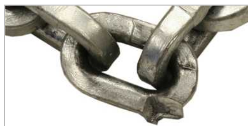
Endommagement mécanique du maillon de chaîne.
