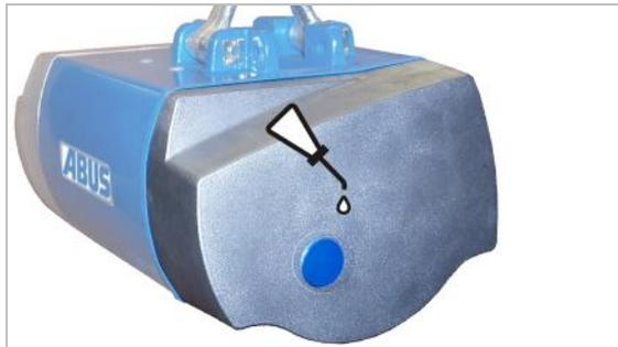
Schmierung ab Werk durch Schmierstoff mit der Normbezeichnung CLP ISO VG 460 DIN 51502.
