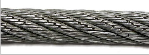
Birden fazla tel kopması. Tel kopmaları, halatın normal aşınmasının bir işaretidir. Bunlar, halatın yük altında halat makaraları üzerinde bükülmesinden kaynaklanmaktadır.
