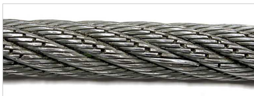
Flera trådbrott. Trådbrott är spår på normalt slitage av linan. De uppstår när linan böjs på grund av att den belastas på linskivorna.
