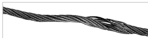
Vaijeriin on muodostunut kori. Näin tapahtuu esim. siinä tapauksessa, että vaijeri kierretään auki väkivalloin.
