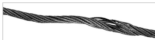
Na lanu se vytvořila deformace. Vzniká např. násilným rozmotáním lana.
