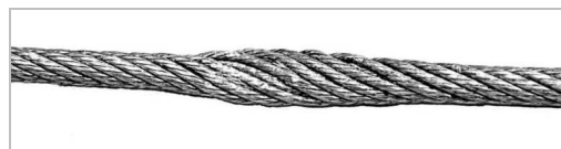
Lano je na jednom místě zploštěné. Tento jev vzniká např. při stlačení lana.
