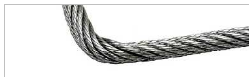
V laně je zlom. Vzniká např. násilným vnějším působením síly na lano.
