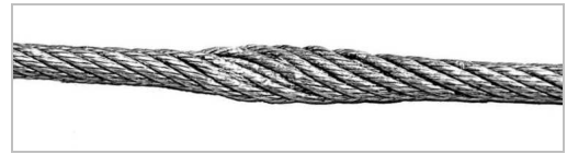
Halatın belli bir noktasında yassılaşma var. Bu durum, halatın ezilmesi sonucu meydana gelir.
