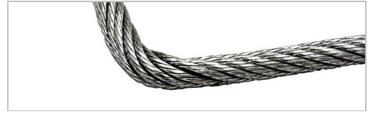
Halat içinde bir kıvrım var. Bu kıvrım, dıştan zorlanma sonucu halata kuvvet uygulandığında oluşur.
