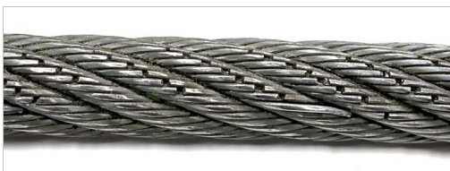
Flere kabelbrudd. Kabelbrudd er tegn på normal slitasje på vaieren. De oppstår når vaieren bøyes på vaierullene under last.
