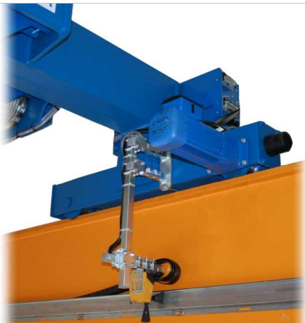
Kruisschakelaar als eindschakelaar loopwerk loopkat
