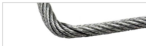
Vaijerissa on taitekohtia. Näitä syntyy esim. vaijeriin kohdistuvan suuren ulkoisen voiman vaikutuksesta.
