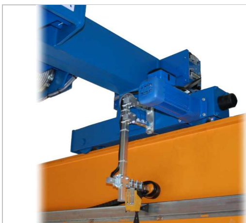
Ristivipukytkin kulkuvaunun rajakatkaisijana
