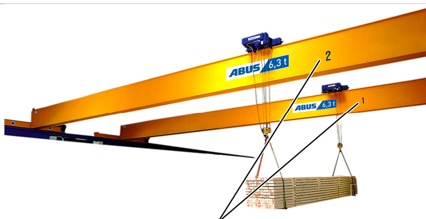
Dwie dźwignice sterowane tandemowo
