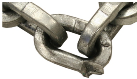
Kättinglänken har mekaniska skador.
