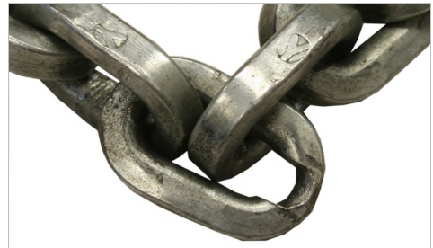
Kjettinglenken er svært slitt.
