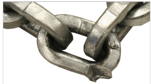
Kjettinglenken er mekanisk skadet.
