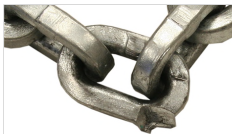
L'anello della catena è danneggiato meccanicamente.
