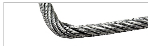
Nella fune c'è una piega. La piega si è formata in seguito all'applicazione di un'eccessiva forza esterna sulla fune.
