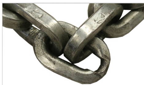
L'anello della catena è fortemente usurato.
