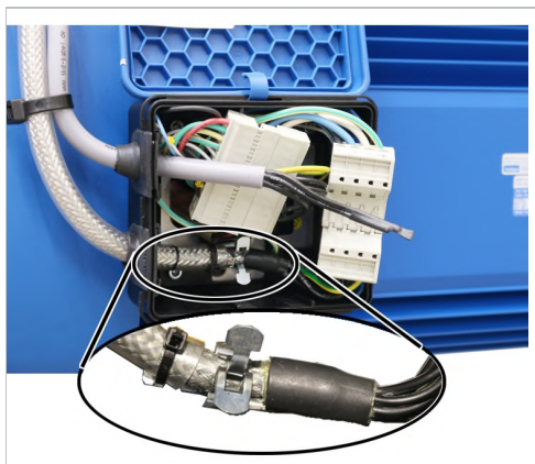
clip de blindage dans le boîtier du connecteur
