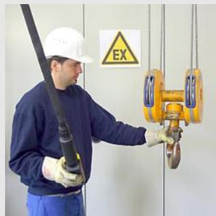
In Schützkästen am Kran oder im Hängetaster entstehen elektrische Funken, die Gase zur Explosion bringen können.
