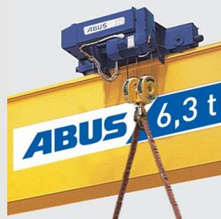
Bei bestimmten Anschlagmitteln und Kran-Bauarten kann es zu gefährlichen Situationen kommen, wenn der Lasthaken ganz nach oben fährt. Zum Beispiel kann eine Traverse unter den Hauptträger eines Zweiträgerlaufkrans prallen. Oder eine Rundschlinge kann am Hauptträger eines Krans mit Seitenlaufkatze aufgerissen werden.
