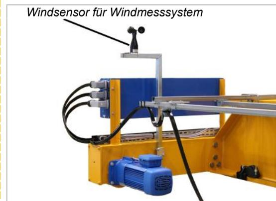
Der Kran muss mit einem Windmesssystem ausgerüstet sein. Das Windmesssystem warnt, wenn eine bestimmte Windgeschwindigkeit überschritten wird. Dann muss der Kran innerhalb einer vorgegebenen Zeit zu seiner Ruheposition (an das Ende der Kranbahn) verfahren werden.
