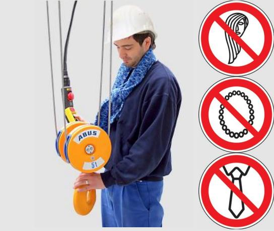
Bei allem, was lose am Körper hängt (z. B. Schmuck, offene Jacken, Schals, lange Haare, Krawatten) besteht die Gefahr, versehentlich damit am Kran hängen zu bleiben (z. B. am Lasthaken beim Heben einer Last oder in einem Motor bei Instandhaltungsarbeiten).
