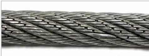
*Mehrere Drahtbrüche. Drahtbrüche sind Spuren des normalen Verschleißes des Seils. Sie entstehen, wenn das Seil unter Last auf den Seilrollen gebogen wird.*
