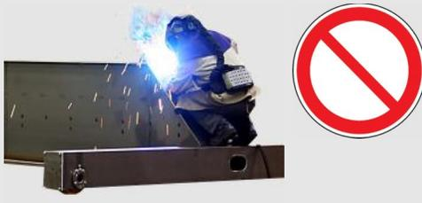
Durch Hitzeeinwirkung bei Arbeiten am Kran (z. B. Schweißen, offene Flammen, Funkenflug) können Teile in Brand geraten.
