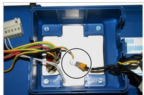
Kabelschuh im Steckergehäuse
