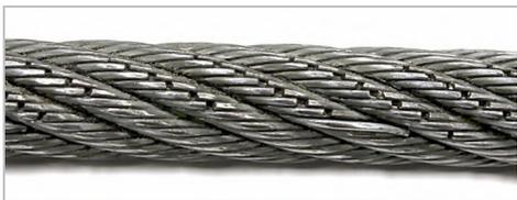
*Várias rupturas do arame. Rupturas do arame são vestígios do desgaste normal do cabo. Formam-se quando o cabo é dobrado sob carga sobre as polias do cabo.*
