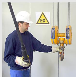
Em caixas de relés no guindaste ou na botoeira pendente, formam-se faíscas elétricas que podem causar a explosão de gases.
