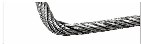
*Existe uma dobra no cabo. Ela se forma pela ação de altas forças externas sobre o cabo.*
