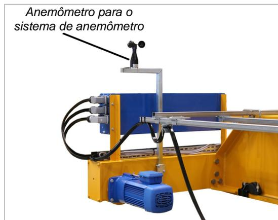
O guindaste deve estar equipado com um sistema de anemômetro. O sistema de anemômetro avverte quando determinada velocidade do vento é ultrapassada. Então o guindaste deve ser movido à sua posição de repouso (ao final da via de rolamento) dentro de determinado tempo.
