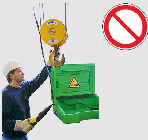
Vapores e substâncias agressivas (por exemplo, ácidos e lixívias) agredem e decompõem peças metálicas ou plásticas no guindaste.
