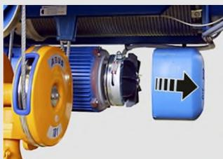
Se as coberturas forem removidas (por exemplo, tampa da caixa de comando, cobertura do ventilador, tampa do motor, ...), as zonas perigosas não estarão mais protegidas.
