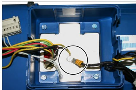
Terminal de cabos na caixa de conexão
