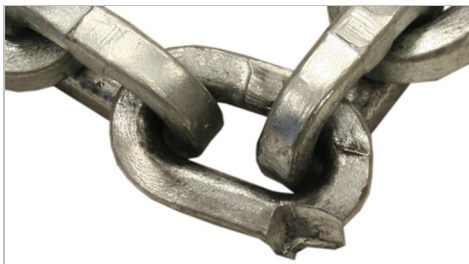
Kättinglänken har mekaniska skador.
