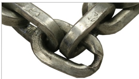
L'anello della catena è fortemente usurato.
