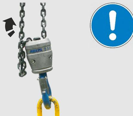
Si la charge est soulevée lorsque la chaîne du palan à chaîne est relâchée, elle risque de se coincer dans le moufle inférieur. Elle peut alors se détacher lorsque la charge est en suspension. La charge risque alors de tomber et de blesser ou tuer des personnes.
