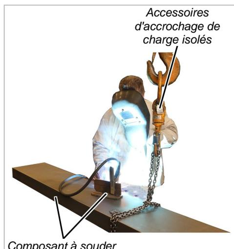
Si le pont est utilisé pour maintenir des composants sur lesquels des travaux de soudage sont effectués, utiliser absolument un accessoire d'accrochage de charge isolé (ex. : émerillon isolé, élingue ronde faite de matériau non-conducteur).
