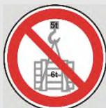
Le poids de l'équipement d'accrochage de la charge (ex. : traverses) peut être très élevé et réduire ainsi la capacité maximale du pont.
