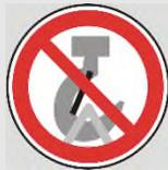
Si le linguet de sécurité du crochet n'est pas fermé, les accessoires d'accrochage de charge ou l'équipement d'accrochage de la charge peuvent sortir involontairement du crochet de levage.
