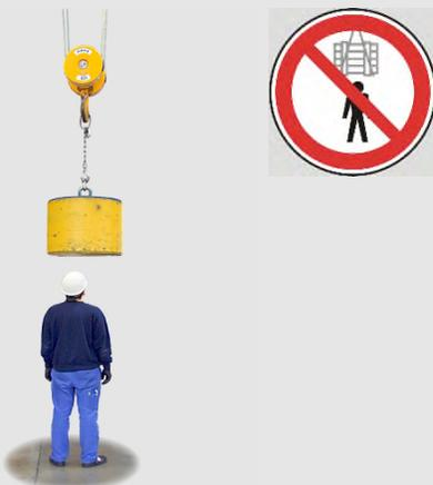
Si la charge n'est pas correctement élinguée ou en cas de rupture des accessoires d'accrochage de charge, la charge peut tomber.
