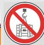
Si la capacité maximale est dépassée, le pont et la charpente portante peuvent être endommagés.
