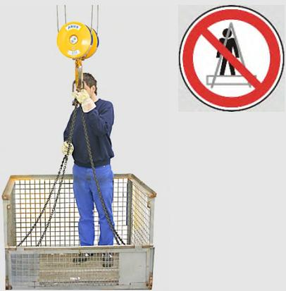
Le pont n'est pas équipé des dispositifs de sécurité nécessaires au transport de personnes.
