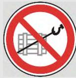
Si une charge suspendue est tirée ou traînée en biais (par exemple au-dessus du sol), le chariot de direction risque, sous l'effet des forces latérales, de basculer et de tomber. De plus, le mouvement oblique du câble ou de la chaîne endommagerait le chariot de direction.
