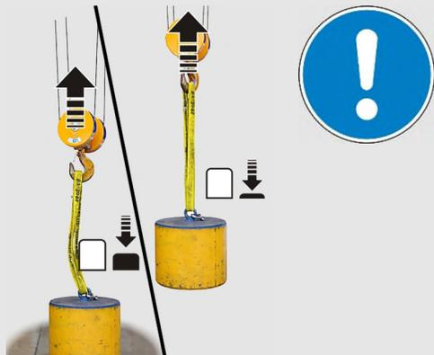
Si la charge est brusquement soulevée du sol à vitesse de levage rapide, le pont est soumis à des contraintes importantes et risque d'être excessivement sollicité. Cet à-coup brusque est encore renforcé si les accessoires d'accrochage de charge sont détendus et si la vitesse de levage rapide est immédiatement enclenchée.
