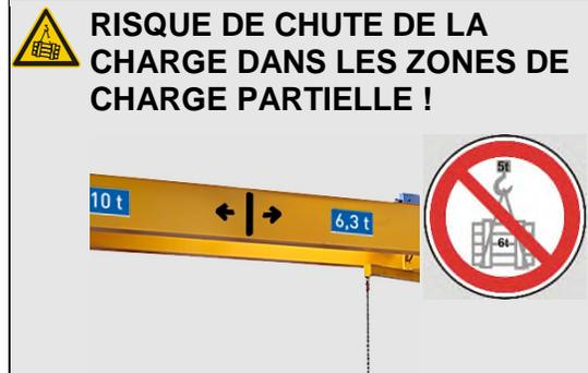
Les capacités maximales du pont diffèrent en fonction de la position du chariot. Si la capacité maximale est dépassée, le pont et la charpente portante peuvent être endommagés.
