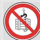
La chaîne du palan à chaîne ou le câble du treuil à câble ne sont pas des accessoires d'accrochage de charge. Tout pliage ou toute pose autour d'arêtes vives les endommagerait.
