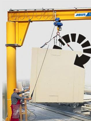
Si une charge est retournée dans les accessoires d'accrochage de la charge ou l'équipement d'accrochage de la charge, elle peut basculer brusquement. Le choc ainsi provoqué peut entraîner la chute du chariot.
