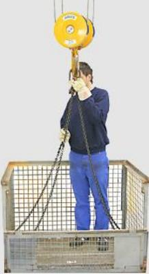
Der Kran ist nicht mit den nötigen Sicherheitseinrichtungen ausgestattet, um Personen sicher zu transportieren.
