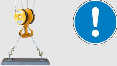
Wird ein Doppelhaken einseitig belastet, neigt er sich zu der belasteten Seite oder kann beschädigt werden. Wenn der Hakenschaft belastet wird, kann der Lasthaken beschädigt werden. Dadurch kann das Anschlagmittel aus dem Lasthaken rutschen und die Last abstürzen und Personen töten oder verletzen.
