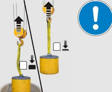
Durch den Ruck beim Heben vom Boden mit schneller Hubgeschwindigkeit wird der Kran stark belastet und kann überlastet werden. Dieser Ruck wird verstärkt, wenn das Anschlagmittel schlaff hängt und direkt auf schnelle Hubgeschwindigkeit geschaltet wird.
