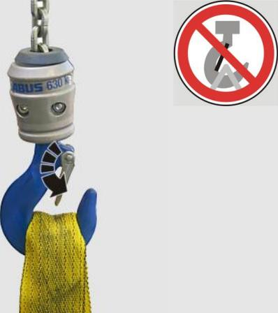
Wird die Hakenmaulsicherung nicht geschlossen, kann das Anschlagmittel oder das Lastaufnahmemittel versehentlich aus dem Lasthaken rutschen.
