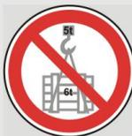
Das Gewicht des Lastaufnahmemittels (z. B. Traversen) kann sehr hoch sein und dadurch die maximale Tragfähigkeit des Krans reduzieren.
