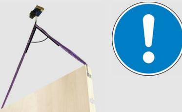
Wird der maximale Spreizwinkel oder die maximale Tragfähigkeit des Anschlagmittels überschritten, kann es reißen.
