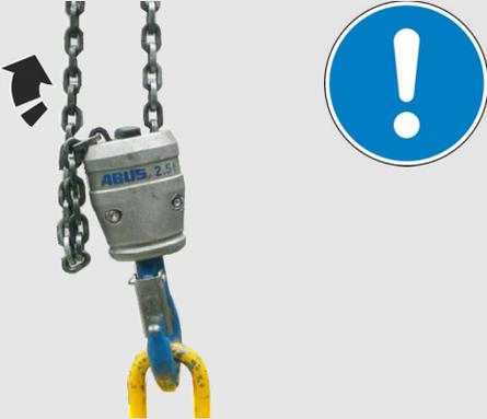
Wird die Last angehoben, wenn die Kette des Kettenzugs locker hängt, kann sie in der Unterflasche verklemmen. Dann kann es passieren, dass sie sich löst, wenn die Last schwebt. Dadurch kann die Last abstürzen und Personen töten oder verletzen.
