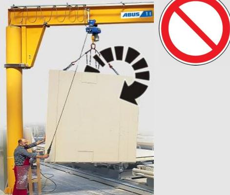
Wird eine Last im Anschlagmittel oder Lastaufnahmemittel umgedreht oder gewendet, kann sie schlagartig kippen. Durch den starken Ruck kann die Katze herunterfallen.
