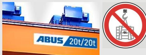
Wird die maximale Tragfähigkeit überschritten, können der Kran und die Tragkonstruktion beschädigt werden.
