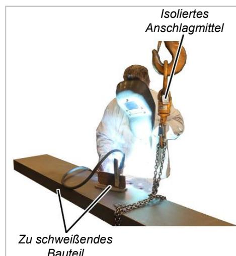
Wird der Kran verwendet, um Bauteile zu halten, an denen geschweißt wird, unbedingt ein isoliertes Anschlagmittel (z. B. isolierten Drallfänger, Rundschlinge aus nicht-leitendem Material) verwenden.
