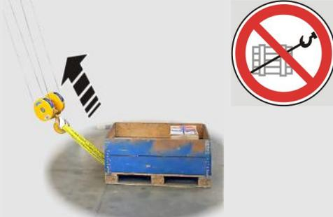
Wird eine angehängte Last schräg (z. B. über den Boden) gezogen oder geschleppt, kann die Katze durch die seitlichen Kräfte kippen und herunterfallen. Zudem wird die Katze durch das schräg laufende Seil bzw. Kette beschädigt.
