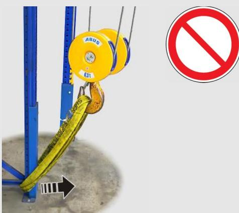
Wird eine feststehende oder verklemmte Last (z. B. festgerostetes oder angeschraubtes Teil) losgerissen, kann die Katze durch den starken Ruck beim plötzlichen Lösen der Last herunterfallen.
