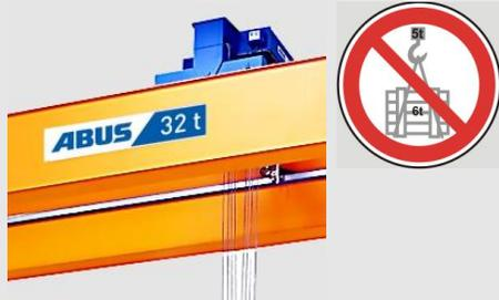
Wird die maximale Tragfähigkeit überschritten, können der Kran und die Tragkonstruktion beschädigt werden.
