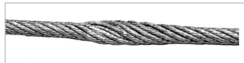
*Das Seil ist an einer Stelle abgeplattet. Dies entsteht durch Quetschung des Seils.*
