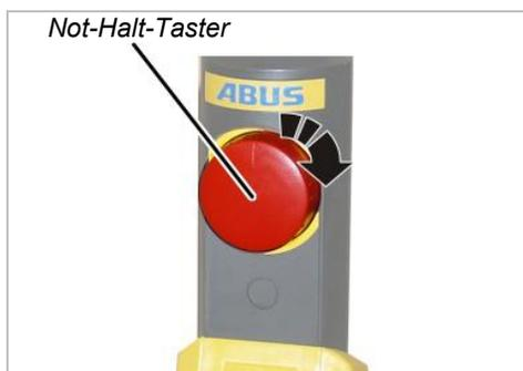
➔ Not-Halt-Taster Viertel-Umdrehung im Uhrzeigersinn drehen.
