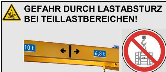
Der Kran hat je nach Position der Katze unterschiedliche maximale Tragfähigkeiten. Wird die maximale Tragfähigkeit überschritten, können der Kran und die Tragkonstruktion beschädigt werden.
