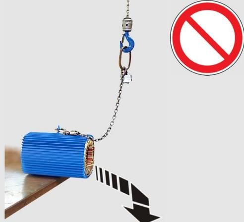
Wird eine Last in den Lasthaken, das Anschlagmittel oder das Lastaufnahmemittel fallengelassen und mit dem Kran aufgefangen (z. B. ein Bauteil wird nur locker eingehängt und dann demontiert), kann die Katze durch den starken Ruck herunterfallen.
