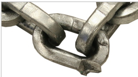
Kædeleddet er mekanisk beskadiget.
