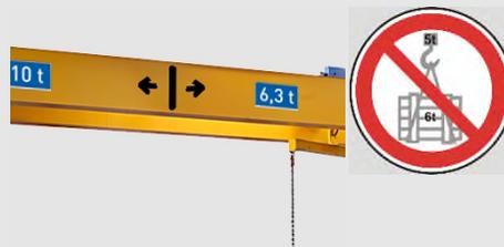
Dependendo da posição do trole, o guindaste tem diferentes capacidades de carga máximas. Se a capacidade de carga máxima for ultrapassada, o guindaste e a estrutura de suporte poderão ser danificados.
