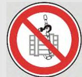
A corrente da talha de corrente ou o cabo da talha de cabo de aço não são meios de amarração da carga. Serão danificados se forem dobrados ou se passarem por cima de cantos vivos.
