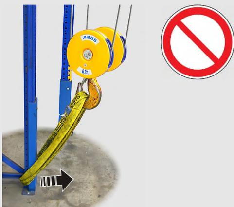
Se uma carga presa ou emperrada (por exemplo, peça presa por ferrugem ou aparafusada) for solta à força, o trole pode cair devido ao forte solavanco causado pela soltura brusca da carga.
