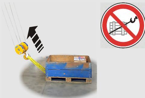
Se uma carga suspensa for puxada ou arrastada de modo inclinado (por exemplo, sobre o piso), o trole pode virar e cair devido às forças laterais. Além disso, o trole será danificado pelo cabo ou pela corrente que se move na diagonal.
