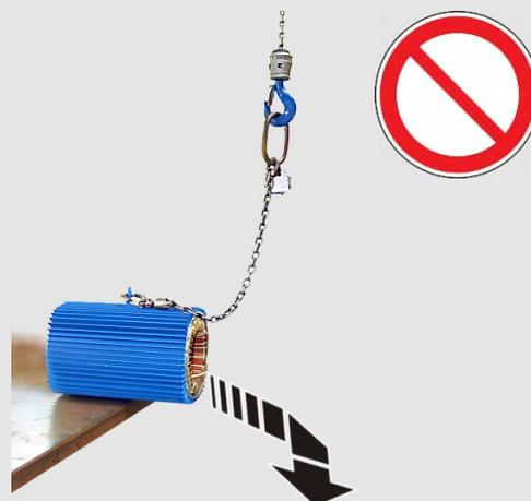
Se uma carga que se encontra no gancho de suspensão, nos meios de amarração da carga ou nos dispositivos de suspensão da carga cair e for pegado pelo guindaste (p. ex., um componente é enganchado apenas de modo frouxo e então desmontado), o trole pode cair devido ao forte solavanco.
