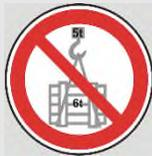
O peso dos dispositivos de suspensão da carga (p. ex., travessas) pode ser muito alto, reduzindo assim a capacidade de carga máxima do guindaste.
