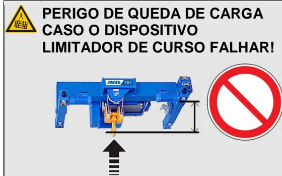
O dispositivo limitador de curso superior (em talha de cabo de aço) e o acoplamento de fricção (em talha de corrente) podem ser danificados pelo uso regular, não funcionando mais, se o gancho de suspensão for movido em posição muito alta ou muito baixa.
