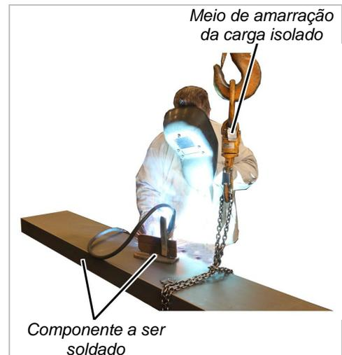
Se o guindaste for utilizado para segurar componentes, nos quais é feita uma soldagem, utilizar imprescindivelmente um meio de amarração da carga isolado (por exemplo, destorcedor isolado, laço de amarração de material não condutor).
