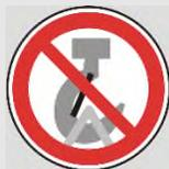
Se o trava-quebras não for fechado, o meio de amarração da carga ou o dispositivo de suspensão da carga pode escorregar por descuido do gancho de suspensão.
