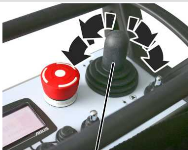
dwustopniowy sterownik joystick
