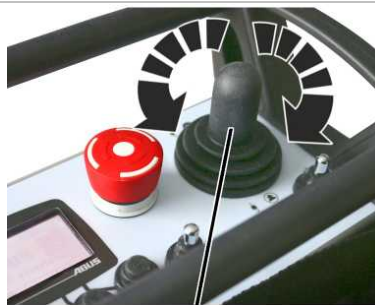
proporcjonalny sterownik joystick
