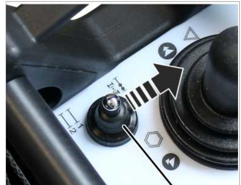
Kääntökytkin "Select trolley" (kulkuvaunun valinta)
