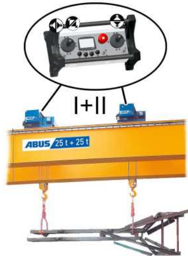
Katvalg I I+II II (Løbekattene kan betjenes skiftevis eller sammen) Skiftevis: Som vist til venstre. Fælles funktion: Fælles funktion af begge løbekatte
