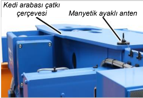
Örnek: Manyetik ayaklı anten, kedi arabası çatkı çerçevesi üzerinde
