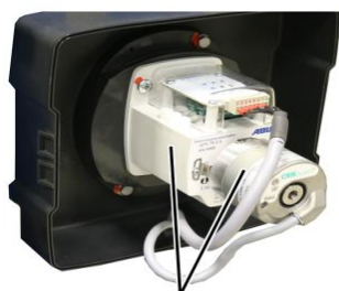
Wyłącznik graniczny przekładni ,GPK‘ z absolutnym enkoderem bębna Kübler‘
