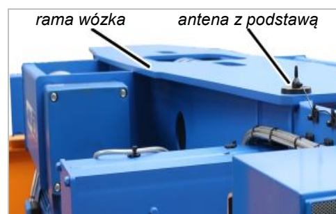
Przykład: antena z podstawą na ramie wózka
