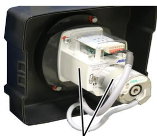
Girendebryter "GPK" med absoluttvinkelgeber "Kübler"
