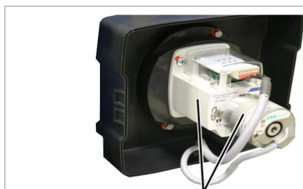
Finecorsa rotativo "GPK" con trasduttore del valore assoluto "Kübler"
